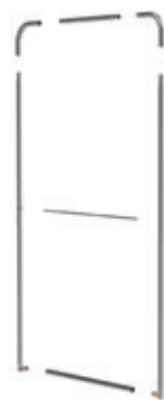
Ajoutez le renfort central et connectez l'ensemble des tubes à l'aide du système de repérage
